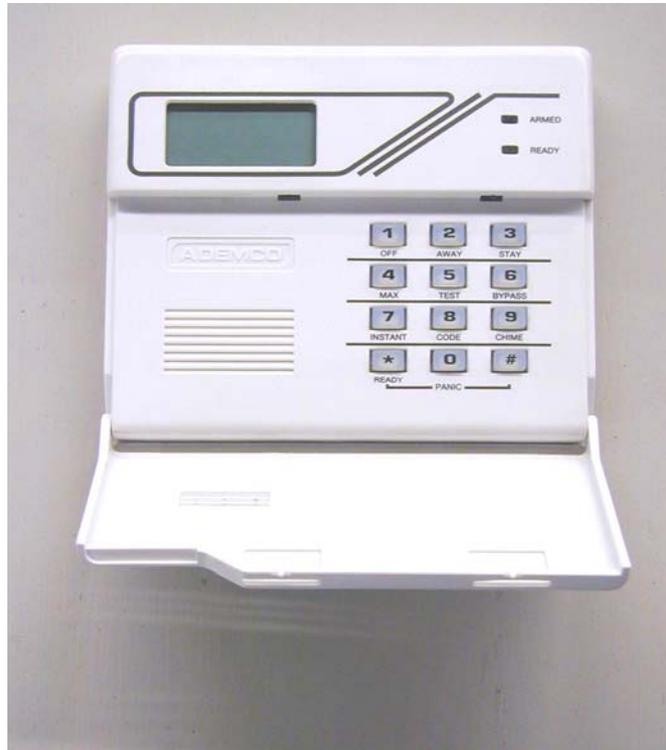
**Figure 48: Intrusion Alarm Keypad**
